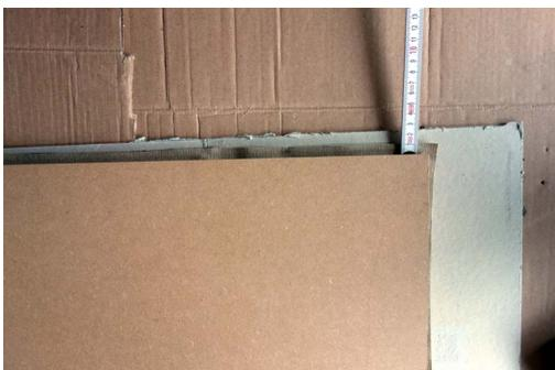
Bild mit Bildseite nach unten auf Schneideunterlage legen (z.B. alter Fußbodenbelag, Karton, größeres Brett usw.) Aufzieh-Brett mittig auf Bildrückseite legen. Allseitig auf gleichmäßige Überstände achten.
