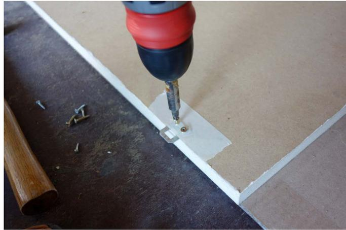
Spanplattenschrauben (Größe 3 x 12 mm oder 3 x 10 mm z.B. von Spax) in die Nagelkerben stecken und in die Holzplatte hineindrehen. Anfangs die Schrauben zwischen den Fingern führen.
